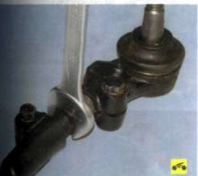
10. ...и выверните регулировочный болт из тяги и наконечника.
