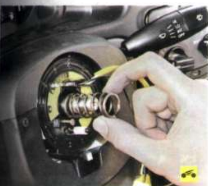
9. Снимите пружину, установленную под рулевым колесом.
