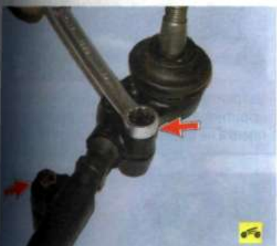
9. Ослабьте затяжку болтов клеммовых соединений.
