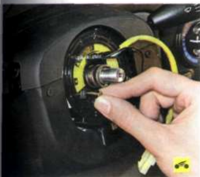
8. Зафиксируйте контактное кольцо подушки безопасности от проворачивания штифтом подходящего диаметра.
