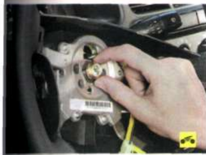
6. окончательно отверните гайку крепления.
