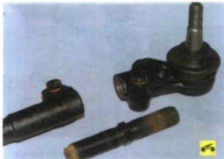
11. Очистите и осмотрите детали рулевой тяги, неисправные детали замените.
