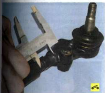
8. Измерьте свободную длину регулировочного болта.
